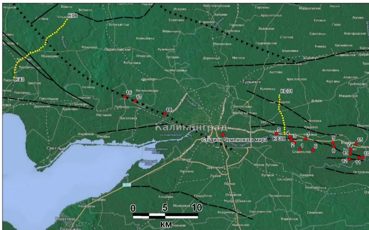
Рисунок 1 – Схема фактического материала на фоне разломов и флексур. Красные кружки – точки наблюдения. Желтые ромбы – точки микросейсмического зондирования. Черными сплошными линиями показаны разломы, установленные на поверхности и в основании чехла; пунктирными — разломы, установленные по данным сейсморазведки и бурения; черными треугольниками — флексурно-разрывные зоны.
